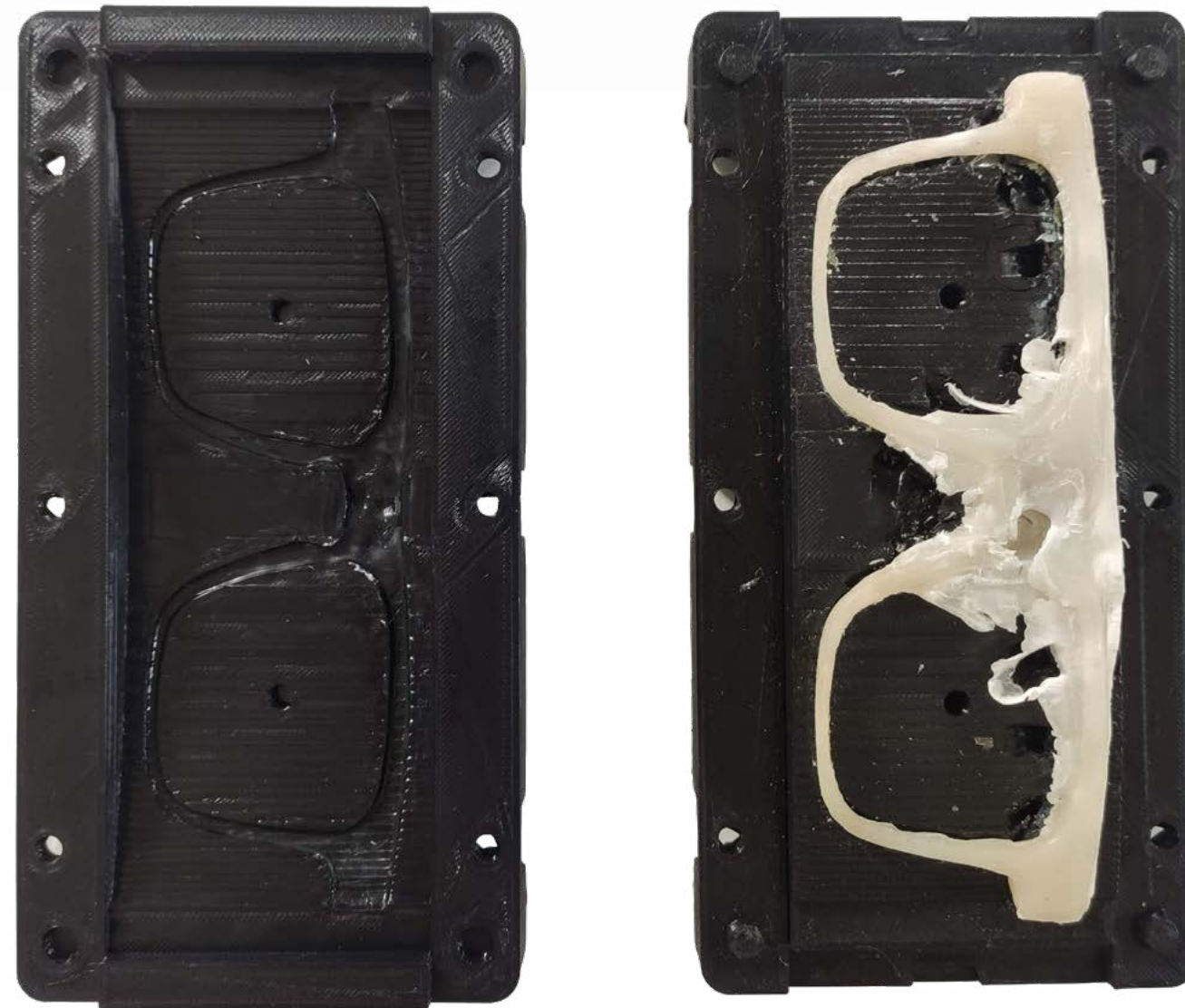
Injection dans un moule en PLA.
